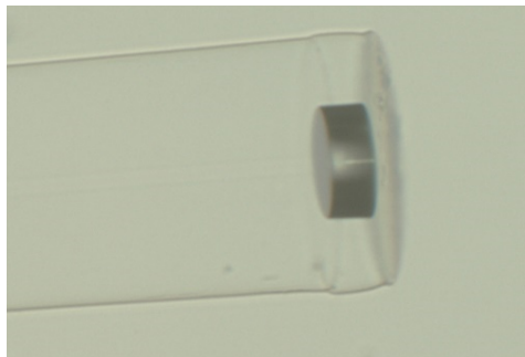
Figure III-24 : Image au microscope à immersion d'un cavité Fabry-Pérot cylindrique de 22 \mu\text{m} avec une membrane de 12 \mu\text{m} .
