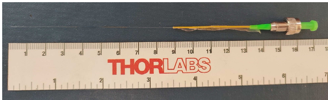
Figure IV-36 : image d'un prototype de capteur testé en pression.
