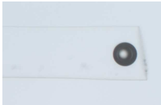
Figure IV-50 : Image au microscope à immersion du transducteur constitué d'une cavité Fabry-Pérot de longueur de 57,8 \mu\text{m} et d'une membrane d'épaisseur de 12 \mu\text{m} - prototype D
