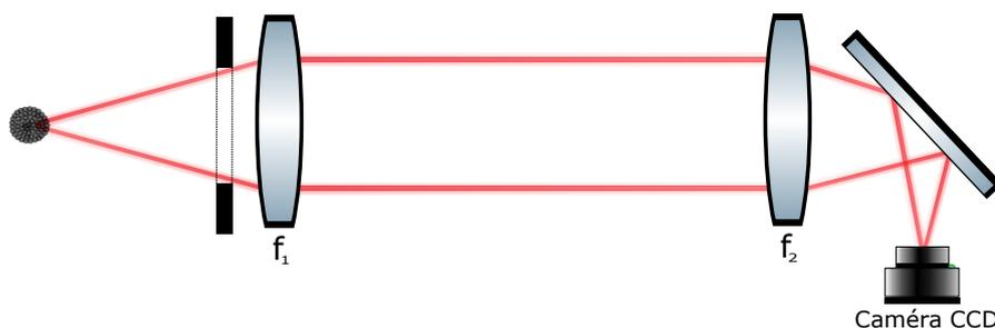
FIGURE 3.8 – Schéma du système d'imagerie du BEC tel qu'il a été construit initialement.  $|M| = 1$ .
