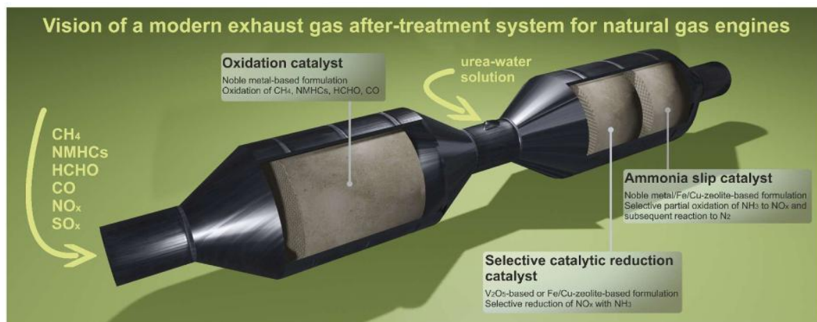
Figure 19 : Représentation d'un pot catalytique d'un véhicule alimenté au gaz naturel [12].
