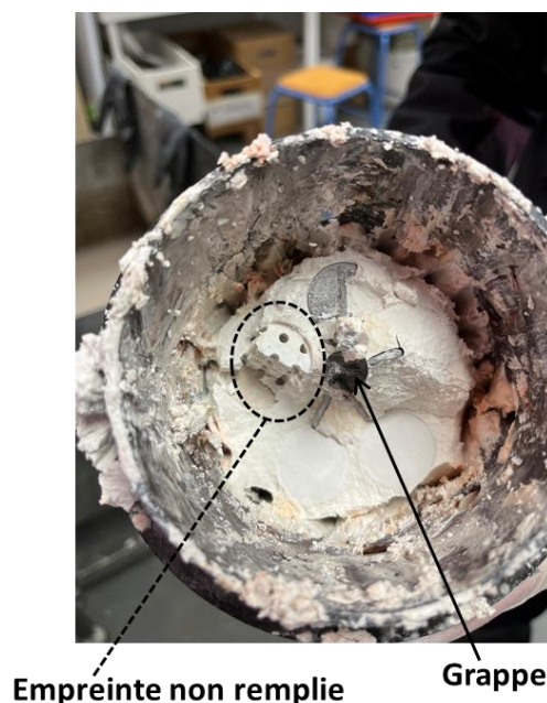
Figure 3.11 : Illustration d'une grappe en cours de dégagement dans le plâtre solide.
