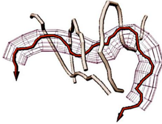
Figure 1.2 : Illustration d'un tube de reptation 39 .
