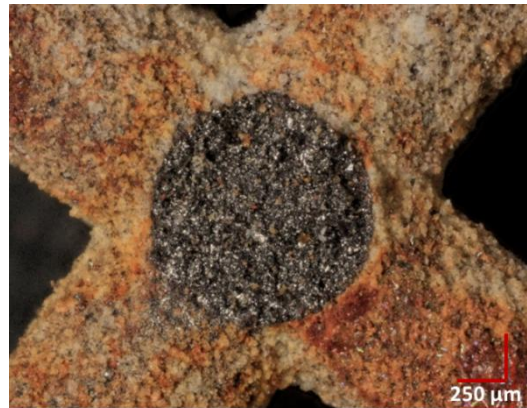
Figure 5.20 : Zoom sur les faciès de rupture au niveau des nœuds.
