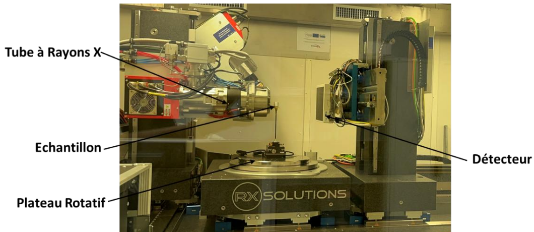
Figure 2.11 : Tomographe RX SOLUTIONS Utilisé dans le cadre de cette étude.
