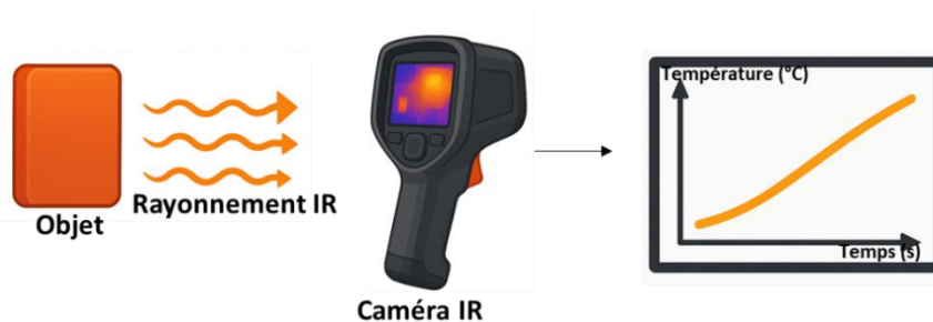
Figure 2.6 : Schéma de principe de la thermographie IR
