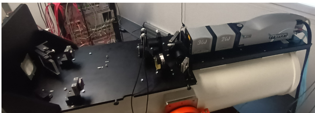
FIGURE 4.12 – Photo du beam expander prise pendant sa phase d’alignement. Le laser à droite de l’image émet en basse puissance à travers le beam expander, et les taches issues du grossissement et de la recombinaison des faisceaux sont observées sur l’écran blanc situé sur la gauche de la photo (LOA, Lille)
