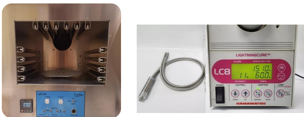
Figure II. 37 : Photographies du réacteur UV (LZC-4V) (à gauche) et de la lampe UV LC8 (à droite)
