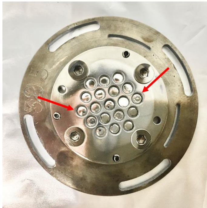
Figure 31 : Echantillons montés sur le porte-échantillon avant irradiation ; les flèches rouges indiquent les endroits où sont insérés les thermocouples permettant de mesurer la température d'irradiation
