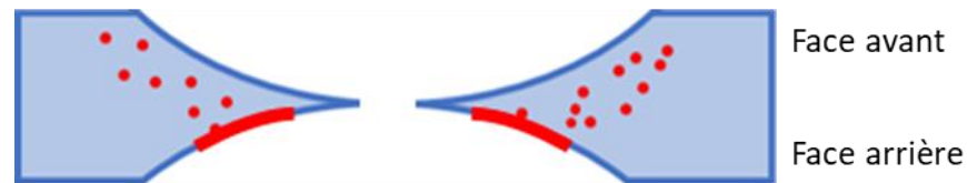
Figure 35 : Illustration du dommage observable sur la face arrière de la lame percée
