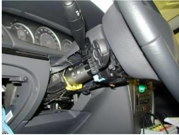
Figure II-2 : Equipement placé en haut de la colonne de direction
