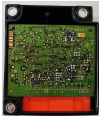
Figure I-2 : Vue ouverte de l'intérieur d'un calculateur d'airbag
