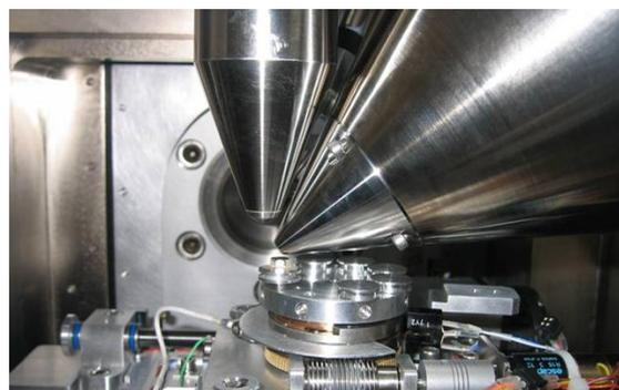
FIG. 2.2 – Colonne MEB verticale, colonne FIB inclinée
