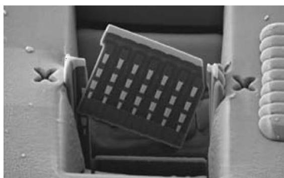
FIG. 2.3 – Lift-off d'une préparation TEM
