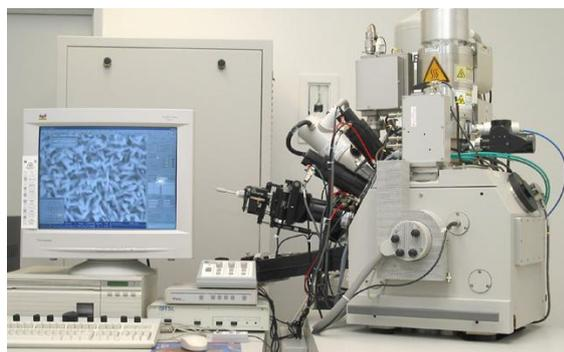
FIG. 2.1 – Photographie d'un microscope dual FIB
