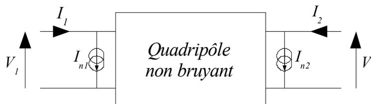
Figure 3.2 : Représentation d'un quadripôle bruyant sous la forme admittance
