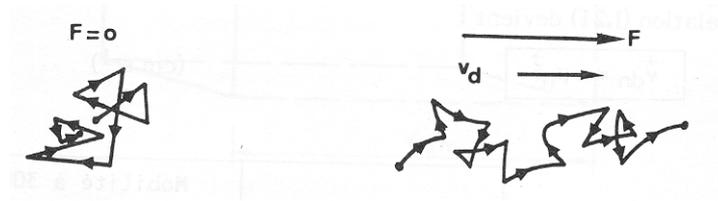
Figure 4.1 : Comportement d'un électron en l'absence et en présence d'un champ électrique [7].
