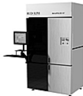
FIG. 2.18: MetaPulse ou l'acoustique picoseconde en boîte (source [2]).
