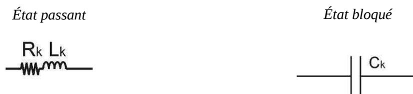
Figure II-10 : Impédances équivalentes à l'IGBT à l'état passant et à l'état bloqué
