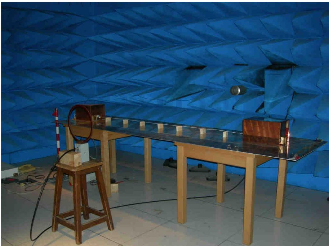
*Figure I-17 : Chambre anéchoïque du laboratoire TELICE*
