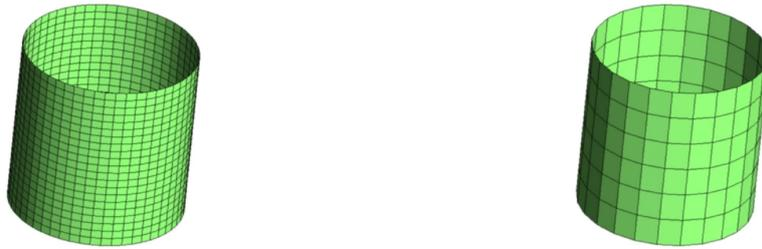
FIG. 2.5 – Exemple de maillages des interfaces fluide (à gauche) et structure (à droite)
