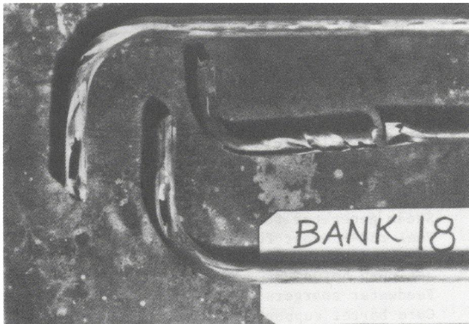
FIG. 1.7 – Visualisation d'un tube de générateur de vapeur endommagé par vibrations [Che87]
