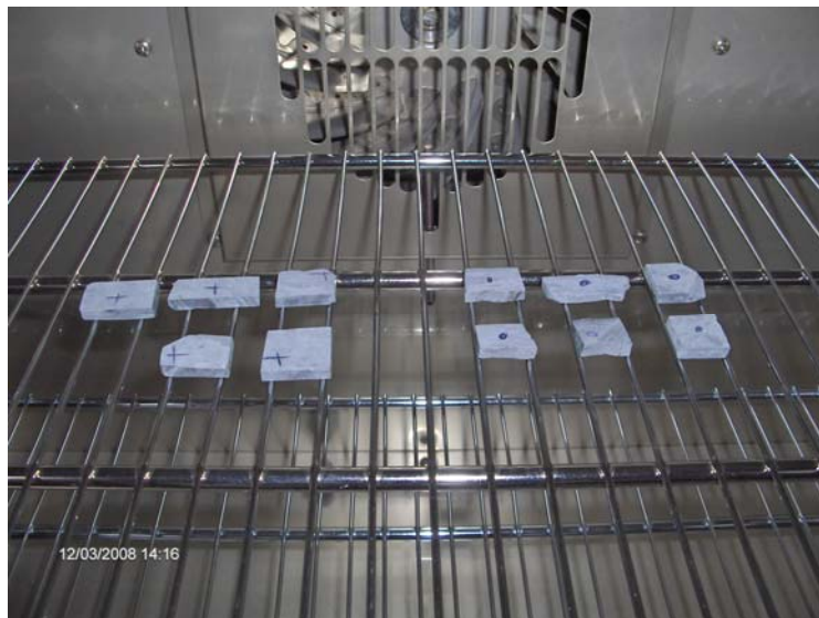
Photo 4.2 : Échantillons du test de MCS dans le four.
