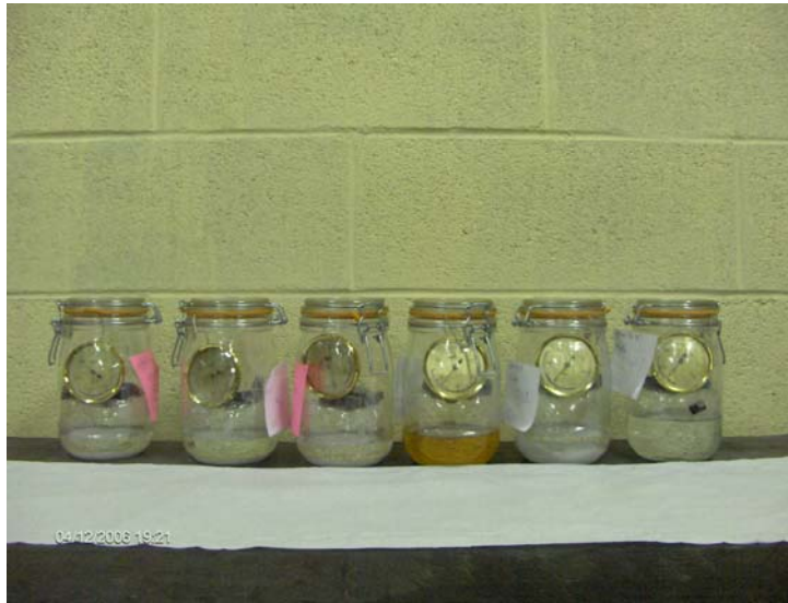
Photo 3.7. Echantillons entreposées dans différentes solutions salines
