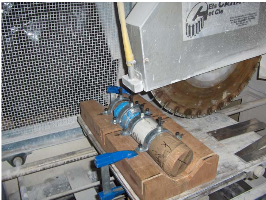
Photo 3.4. Support de fixation adapté aux échantillons et à la scie.
