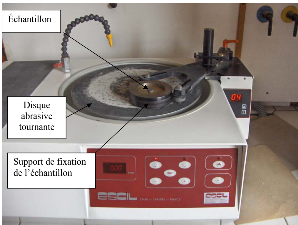
Photo 4.8 : Les différentes parties constitutives de la polisseuse.
