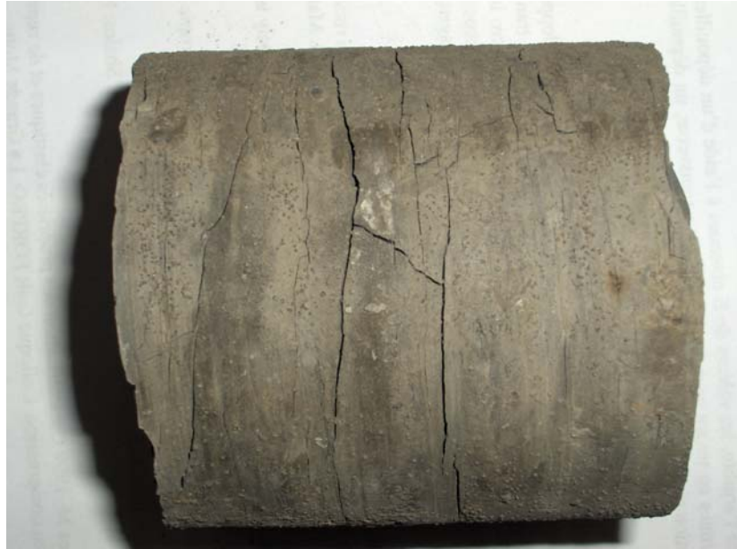
Photo 3.3. Etat initial dégradé de l'argilite de Clearwater
