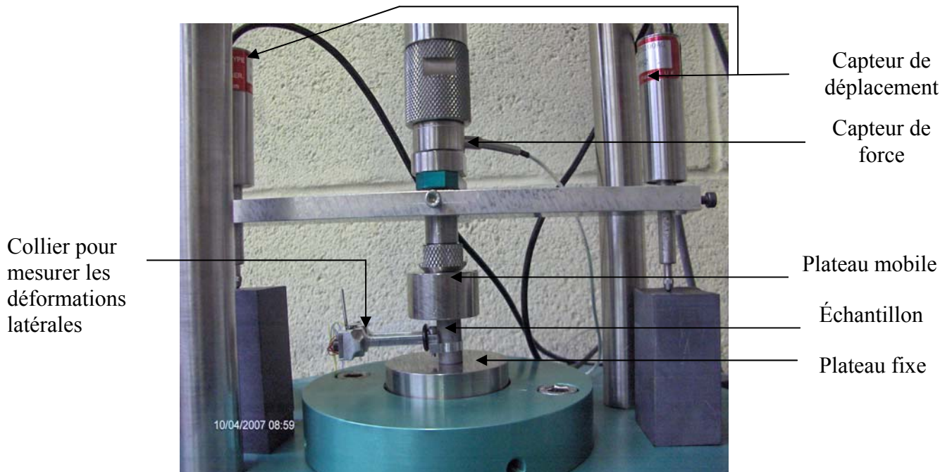
Photo 4.4. Modifications de la machine pour le test de MiniCS
