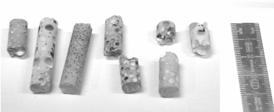
*Fig. 3. 6 - Différents échantillons (diamètre de 8 mm) de composites ciment-billes de verre après différents processus de dégradation (lixiviation, séchage, effet thermique) servant à l'analyse microtomographique.*
