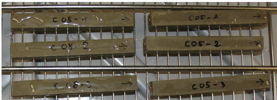
Fig. 2. 6 - Photos des éprouvettes  $20*20*160$  mm des pâtes de ciments C05 et C08
