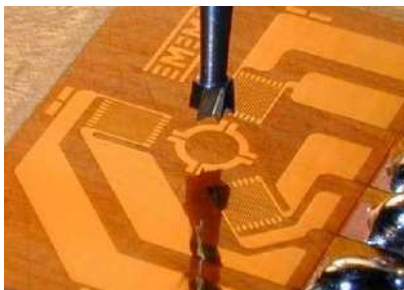
Figura 2.4. Procedimiento de agujereado sobre una roseta especial fijada sobre una superficie [Grand y Lord 2002].
