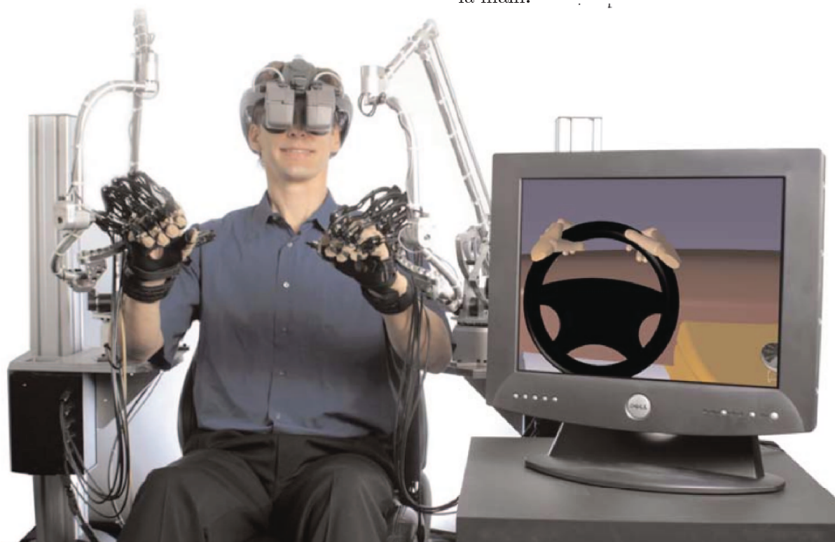
FIG. 5.4 – Le gant RUTGERS MASTER II. La position des actionneurs empêche de refermer la main.
