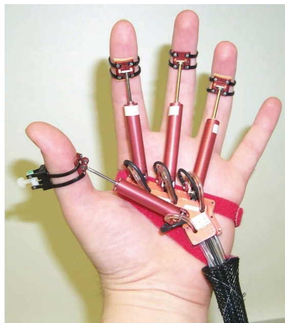
FIG. 5.4 – Le gant RUTGERS MASTER II. La position des actionneurs empêche de refermer la main.
