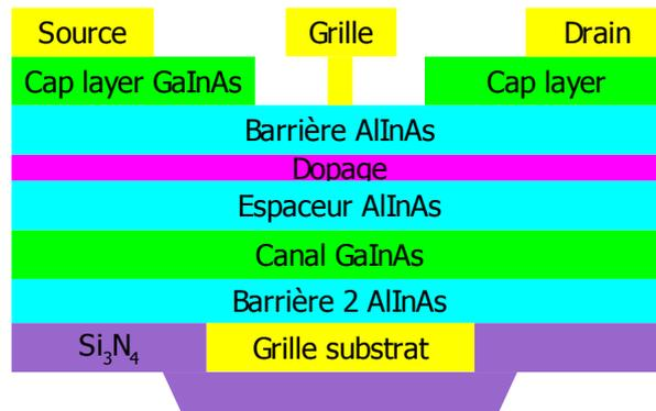
Fig. IV.3.17: Structure d'un transistor de la deuxième série
