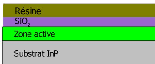
Fig. II.2.4.a: Dépôt de résine
