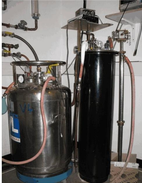
Fig. III.3.3: Grand cryostat et bouteille de l'hélium
