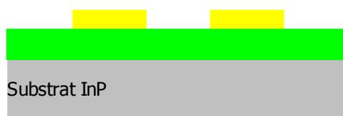
Fig. II.4.3.b: Réalisation des contacts ohmiques
