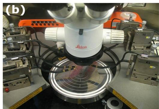
**Figure III.13 :** Vue de la station sous pointes (b).
