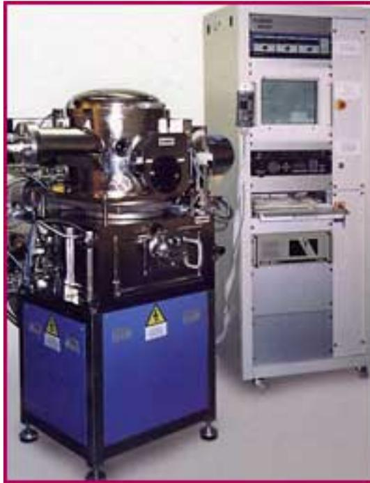
Figure III.2 : Photographie du bâti de métallisation par évaporation.
