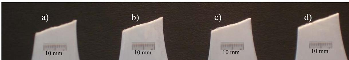
Figure 3.2 : Eprouvettes rompues par traction : a)  $D=0$  (vierge) ; b)  $D= 75\%$ ,  $\sigma_{max}= 200$  MPa ; c)  $D= 75\%$ ,  $\sigma_{max}= 250$  MPa et d)  $D= 75\%$ ,  $\sigma_{max}= 275$  MPa
