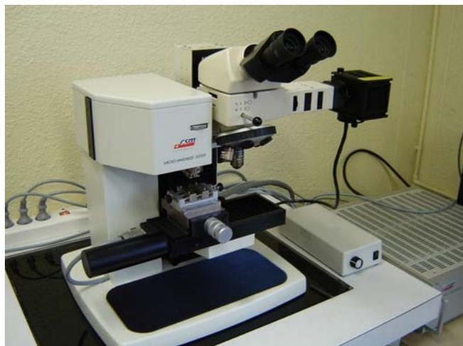
*Figure 2.10 : Machine CSM Instrument pour réaliser des essais de micro-indentation instrumentée*
