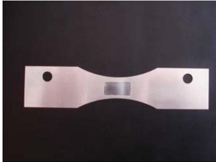
*Figure 2.9 Éprouvette pour les essais de micro-indentation*
