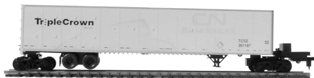
FIG. D.1 – Le système Road-Railer
