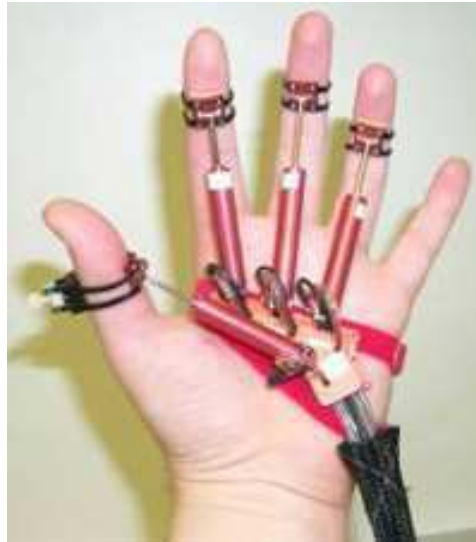
FIG. 1.9 – Exemple de gant haptique à vérins pneumatiques (66)
