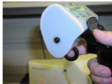
FIG. 1.8 – Interface haptique pour le 'Microrobot Cell' et le panneau de contrôle (77)
