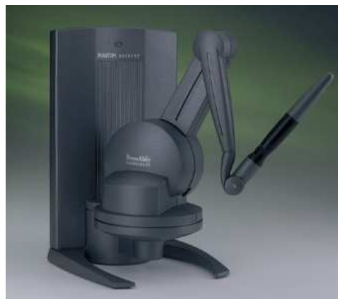
FIG. 1.4 – Phantom de Sensable : système à cabestan (74)
