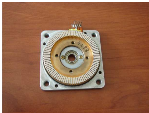
FIG. 1.18 – Stator du moteur à onde progressive (USR60)
