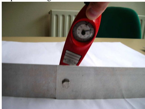
Figure II-19. Procédure de serrage
