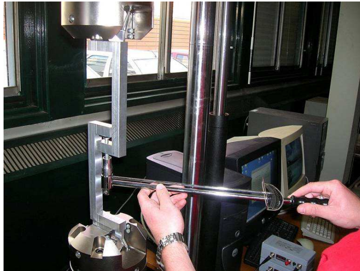
Figure VIII-35. Montage de caractérisation effort/couple.
