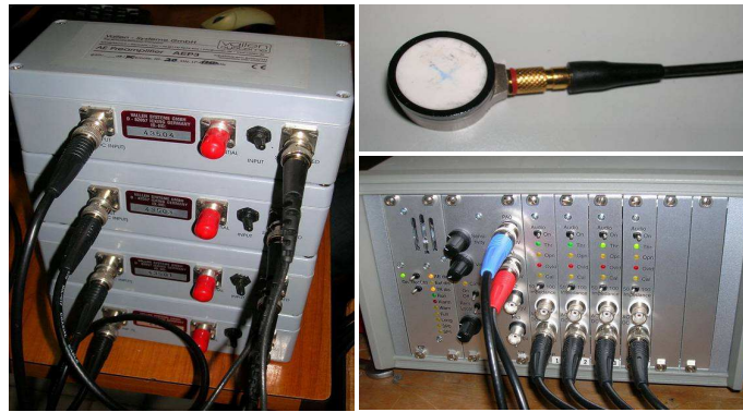
Figure II-9. Capteurs et système d'acquisition EA
