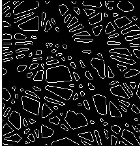
Figure 3-6 : Contours obtenus par l'approche de Canny
