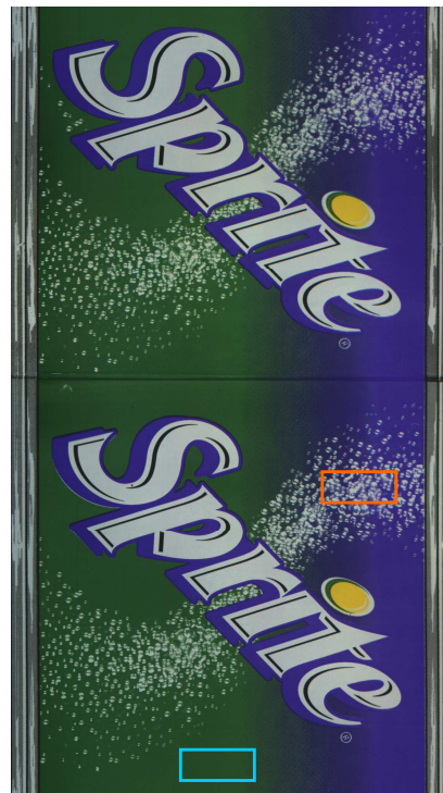
Figure 5.9 : Image du verre de la figure 5.7 : le cadre cyan montre une zone d'analyse de couleur homogène, tandis que le cadre orange, une zone de texture couleur.
