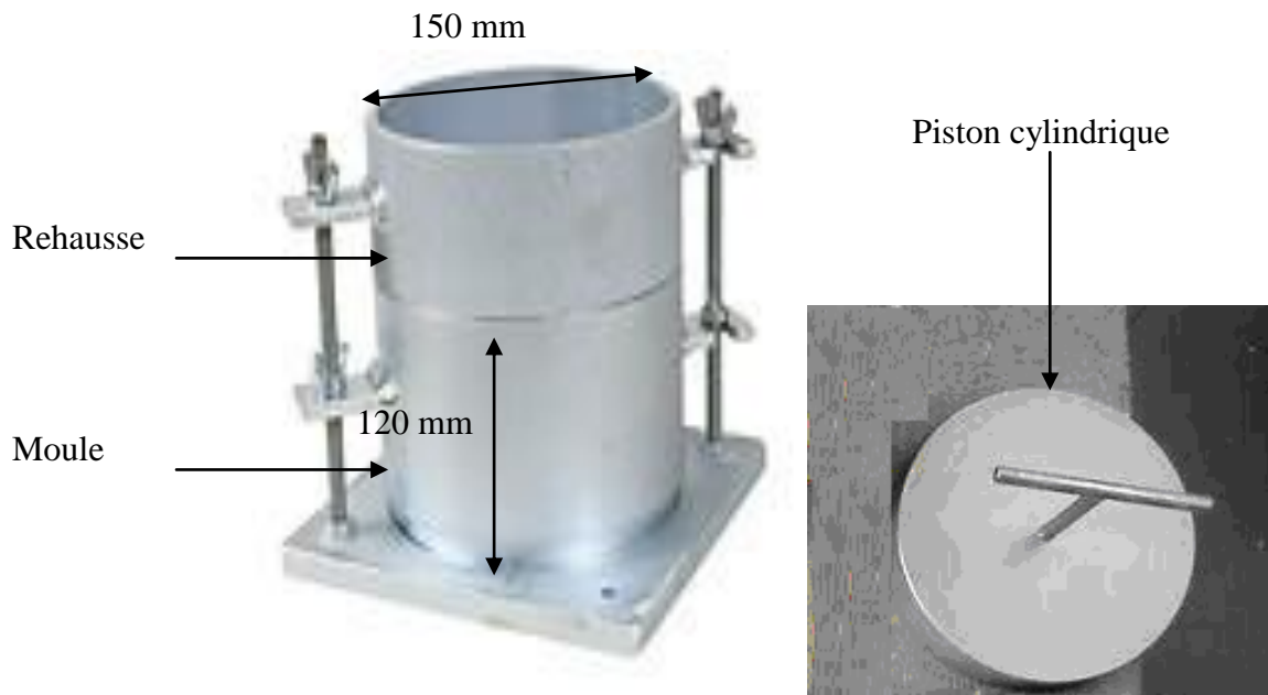
Figure 4.8 : Dispositif expérimental pour les gros granulats.
