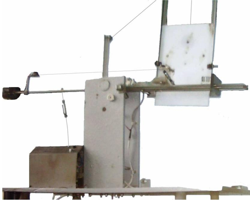
**Figure 79: Dispositif pour déterminer l'hystérésis**
