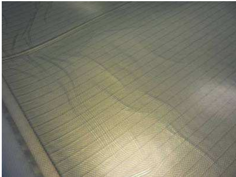
Figure 145 : Plis de l'ETFE observés au dos de la cellule
