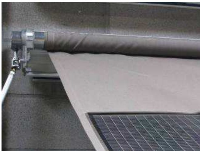
Figure 66 : Plis du store camping-car lors de l'enroulement
