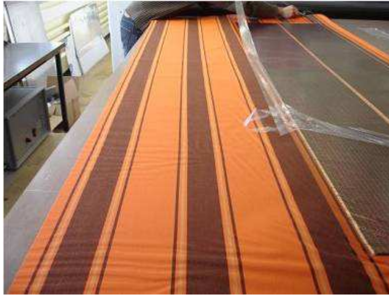
Figure 105 : Toile à structure carrée en sortie de lamineuse. Opération de suppression, du surplus d'ETFE
