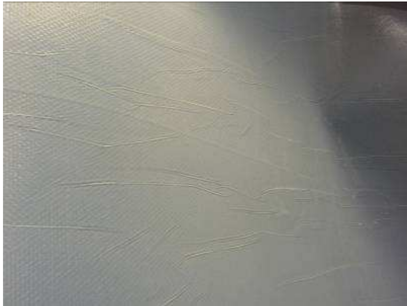
Figure 144 : Plis de l'ETFE observés sur la préforme sans cellule
