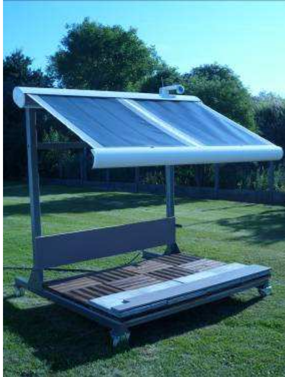
Figure 153 : Store photovoltaïque de petite dimension
