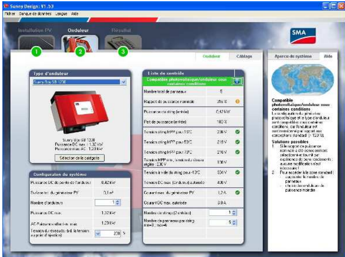
Figure 78 : Simulation du store résidentiel de 5 lés avec un onduleur SMA Sunny SB 1200
