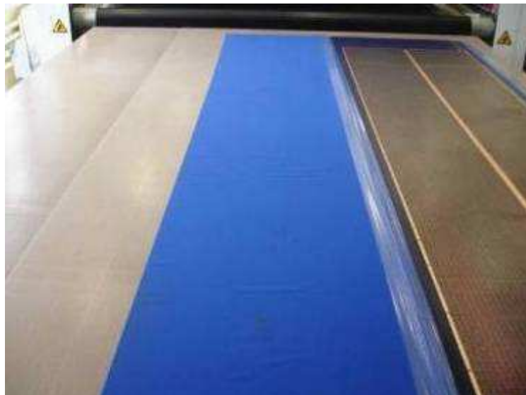
Figure 109 : Résultat final après lamination sur toile « sanforisée »
