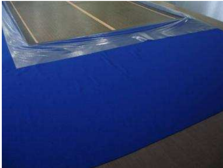
Figure 108 : Résultat final après lamination sur toile « sanforisée »
