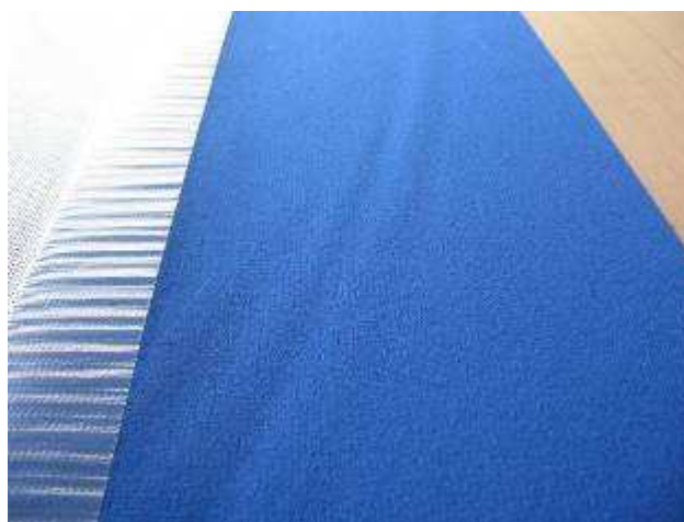
Figure 102 : pli « banane » après lamination
