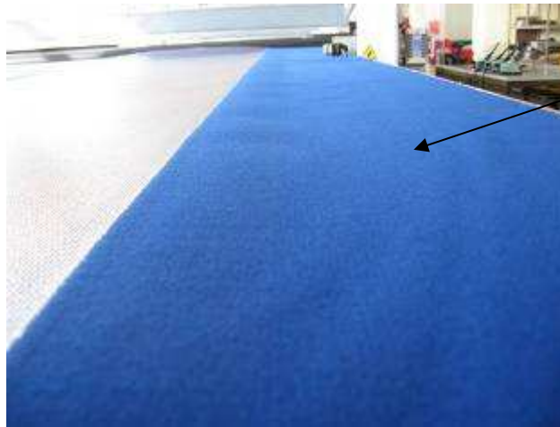
Figure 100 : « plis » après lamination.
