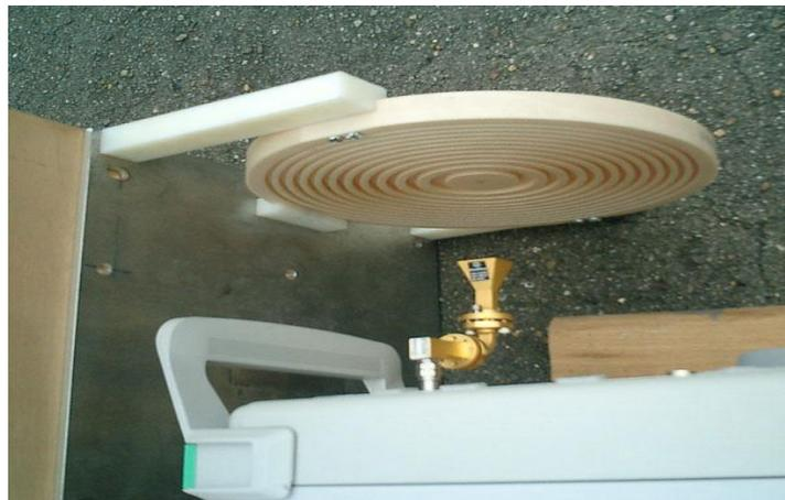
*Figure V.29 : Vue de dessus de la lentille de Fresnel illuminée par l'antenne de type cornet.*
