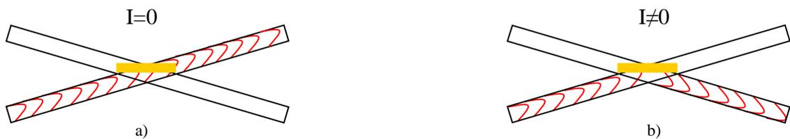
Figure I.7. Commutateur TIR a) Sans polarisation électrique b) Sous polarisation électrique
