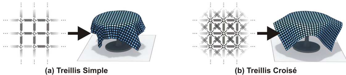
Figure 2.11 - Illustration du problème de configuration du maillage dans les systèmes masse-ressort (cas surfacique). Un treillis simple (a) ne génère pas le même comportement qu'un treillis croisé (b). En effet, même en diminuant la rigidité des ressorts, la simulation (b) semble moins flexible. Cette non-généricité géométrique rend l'identification très complexe lorsque les paramètres de chaque ressort doivent être évalués.
