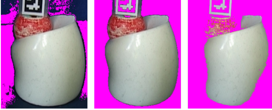
Figure 5.7 - Exemple de détourage automatique sur fond bleu (avec \mathbf{C} = (0, 0.01, 0.20) ) : à gauche, Tol_{coul} = 0.10 , au centre avec Tol_{coul} = 0.25 et à droite avec Tol_{coul} = 0.77 . Pour une meilleure visibilité, le masque calculé est affiché en rose soutenu.
