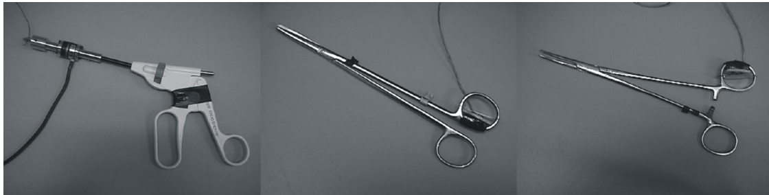
Figure 3.18 - D'après Brouwer ( et al. ) [Brouwer 01] : outils chirurgicaux modifiés pour mesurer les interactions outils/tissus et chirurgiens/outils
