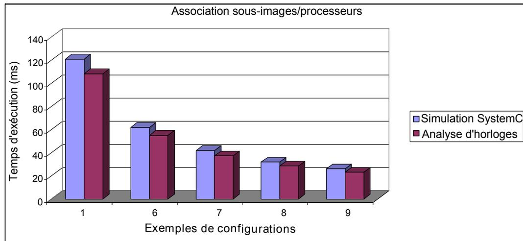
Figure 9.23: Comparaison de temps d'exécution pour différentes configurations de l'architecture (nombre de processeurs) et de l'association de sous-images sur différents processeurs, obtenus durant l'analyse d'horloges abstraites (barres de couleur mauve) et des simulations en SystemC au niveau TLM (barres de couleur bleu).
