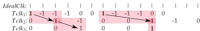
Figure 7.7: Nouvelle trace des horloges ternaires  $Tclk_1$ ,  $Tclk_2$  et  $Tclk_3$  pour des fréquences  $f_1=30$  MHz,  $f_2=15$  MHz,  $f_3=15$  MHz.
