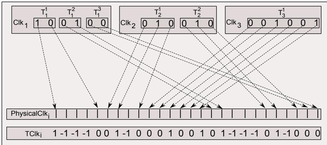
Figure 6.8: Projection des instants de trois horloges fonctionnelles  $clk_1$ ,  $clk_2$  et  $clk_3$  sur une horloge physique *PhysicalClk<sub>i</sub>*, avec  $c_1 = 4$ ,  $c_2 = 2$  et  $c_3 = 1$ .
