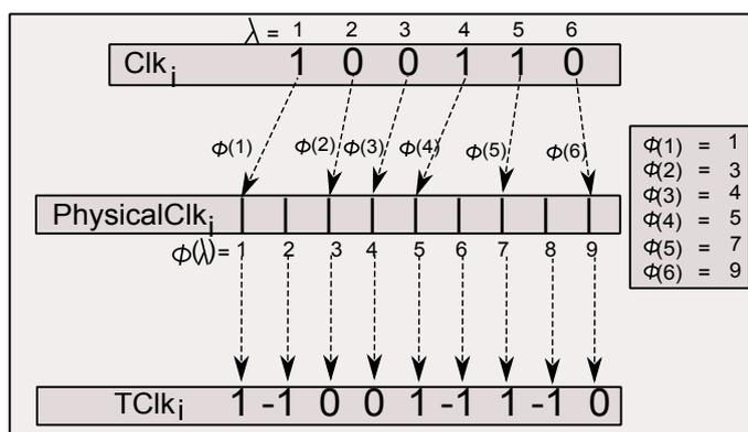
Figure 6.5: Projection des instants de l'horloge fonctionnelle  $clk_i$  sur l'horloge physique  $PhysicalClk_j$ , avec  $c_i = 2$ .
