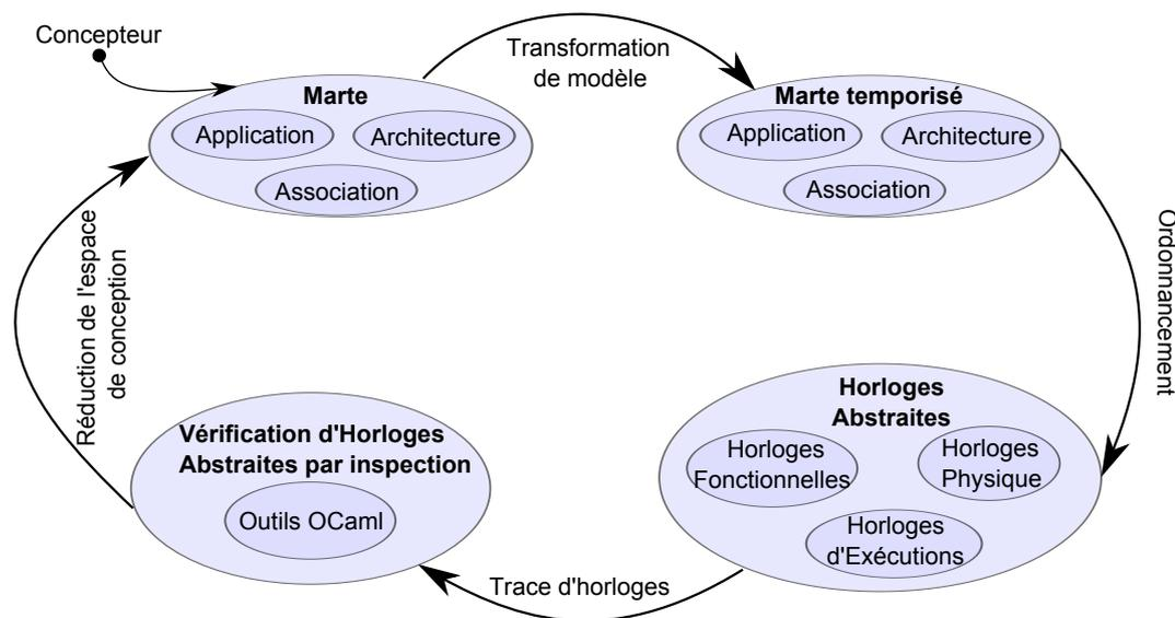
Figure 8.1: Description du noyau de manipulation d'horloges abstraites.
