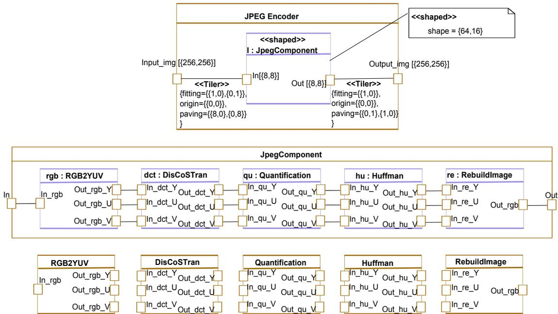
Figure 9.3: Modélisation Marte en Papyrus de l'algorithme de compression/décompression JPEG.
