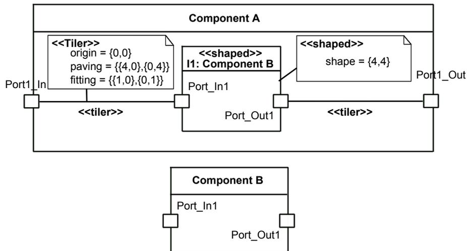
Figure 4.3: Modélisation Marte d'une application avec RSM.
