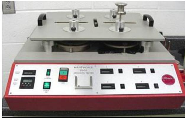
Figure 4.6. Détermination de la détérioration de l'éprouvette selon la norme NF EN ISO 12947-2 (04/99)
