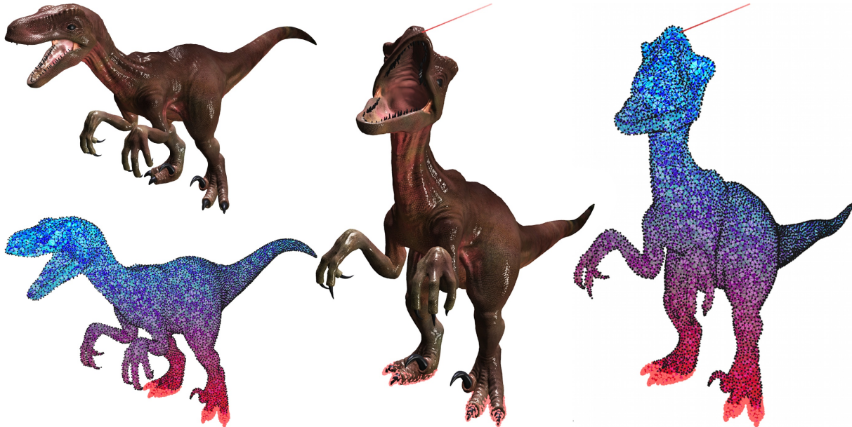
FIG. 3.9 – Un objet déformable (en haut) et son maillage FEM (en bas), soumis à une force externe (ligne rose) et à des contraintes (points roses).
