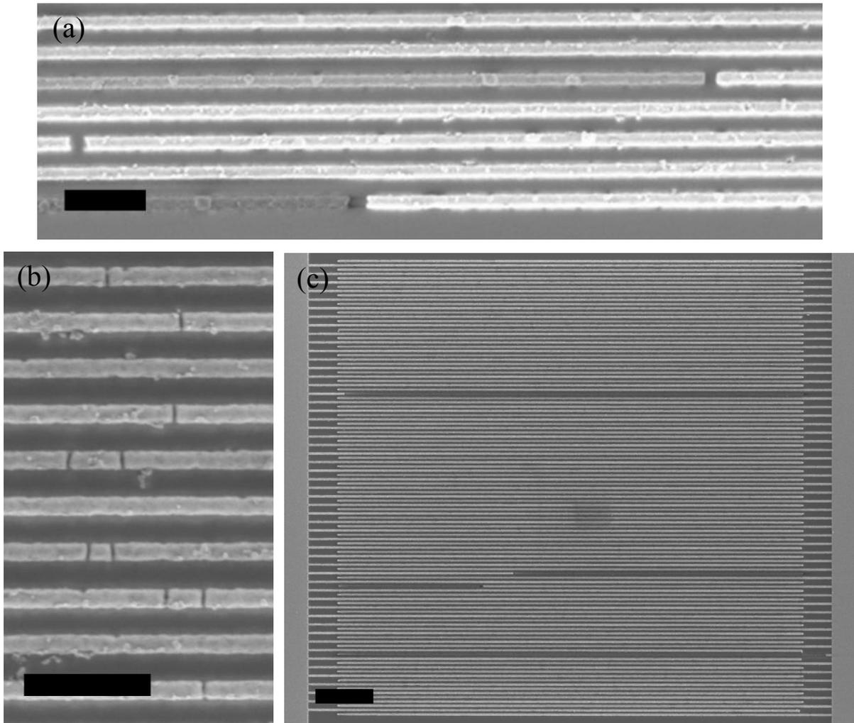
**Figure 5-24** : Images MEB de doigts de peignes cassés. (a) (b) Barre d'échelle = 400 nm. (c) Barre d'échelle = 2  $\mu$ m.
