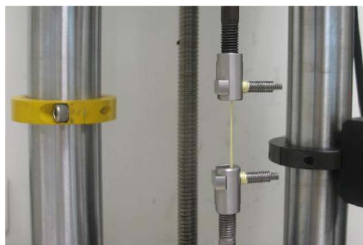
Figure 1.32 – Fixation des fils dans les tests de traction dynamique par les cabestans [TZS08]
