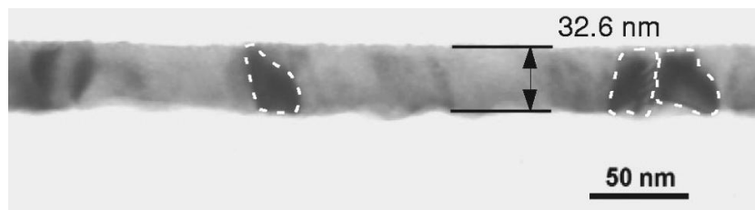
Figure 3-22. Image MET (vue en coupe) d'une couche de PtSi recuit à 300 °C pour une couche de Pt 15 nm déposée [25].
