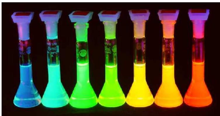
**Figure 1- 3 : Boîtes Quantiques de CdSe classées selon leur taille. Plus les boîtes sont petites, plus elles émettent vers les bleus. (1-19)**
