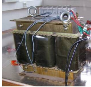
Figure 2.45 : Photo du transformateur triphasé de 15 kVA
