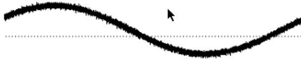
Figure 140: FFT et signal reconstruit d'un signal de fréquence d'entrée 10 GHz échantillonné à 320 MHz, filtres passe bande 110 MHz et 160 MHz en sortie des amplificateurs, échantillon réalisé avec un matériau de durée de vie de 1.4 ps, puissance optique en sortie de fibre lentillée de 0.6 mW, puissance hyperfréquence en entrée de 20 dBm
