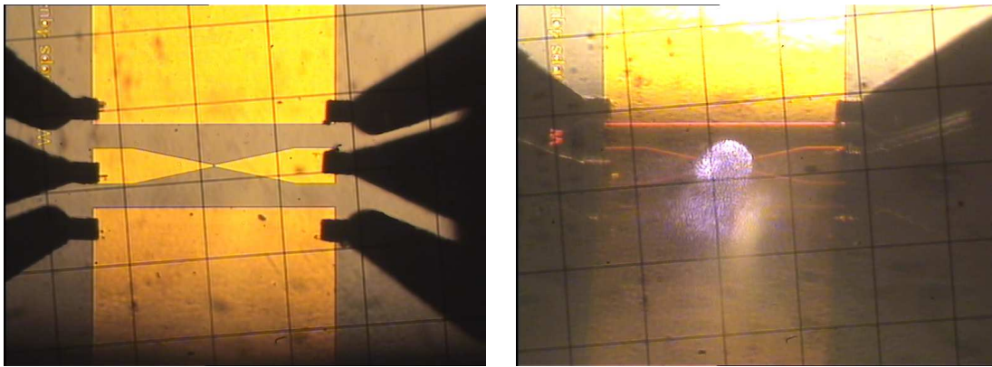
Figure 35 : à gauche la ligne sans éclairement. A droite, même chose mais sous éclairement à 0.8 \mu\text{m} (Banc opto-hyperfréquence du L2E à Paris 6)
