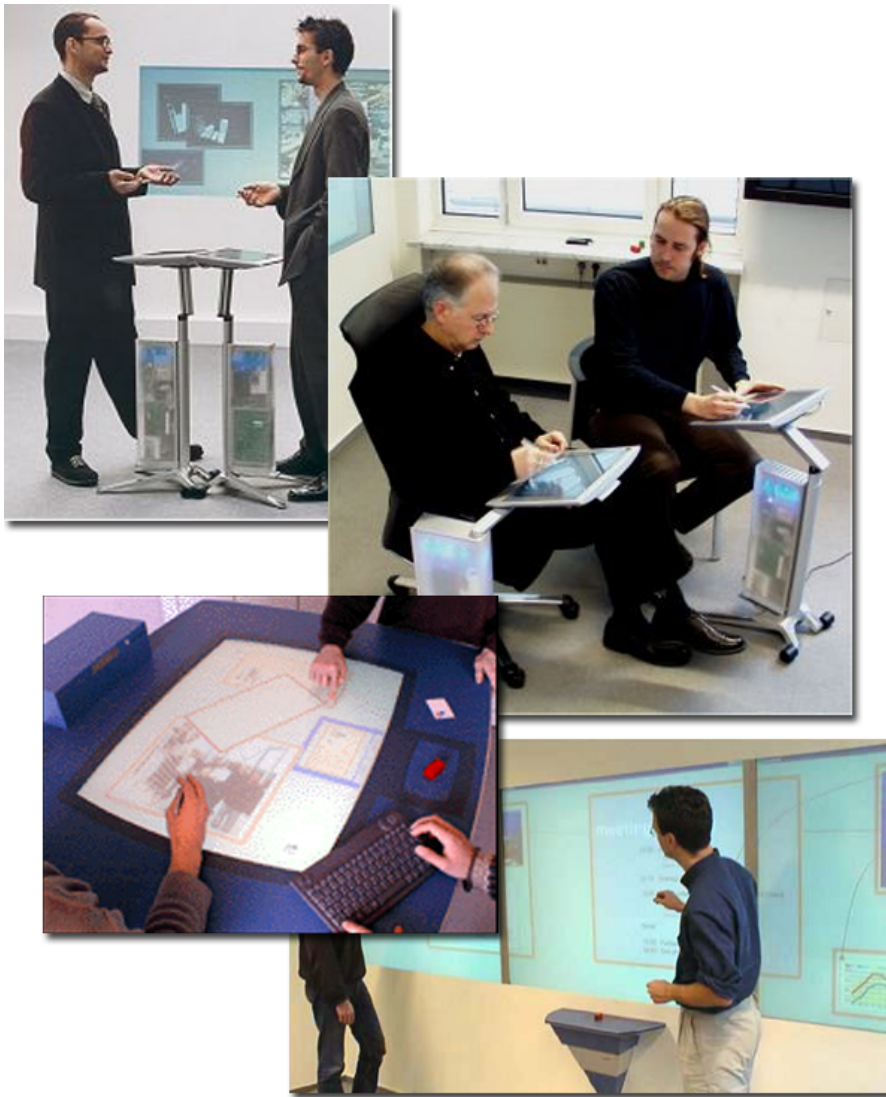
FIGURE 1.15 – Les dispositifs matériels de Roomware. De haut en bas : ConnecTables, CommChairs, InteracTable et Dynawall
