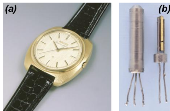
Figure I-9 (a) Seiko Quartz Astron 35SQ : première montre à quartz disponible sur le marché (1969) mise au point par la société EPSON. (b) Diapason quartz de la montre, avec et sans son capot, résonnant à 8192 Hz [68].
