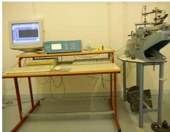
Figure 5.3.1: Les appareils utilisés pour l'essai de cisaillement direct
