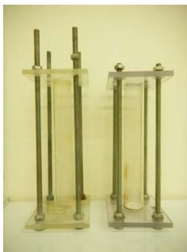
(b): Consolidomètre à  $D=35$  mm
