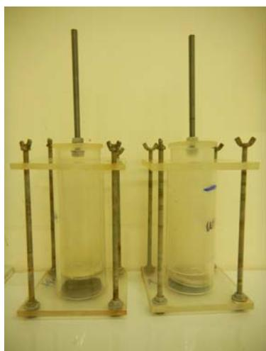
(a): Consolidomètre à  $D=70$  mm
