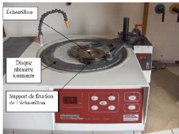
Photo A5 : Photo d'une polisseuse.
