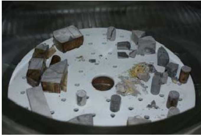
Photo A13 : Photo des échantillons fracturés en enceinte de Hr85% à 80°C
