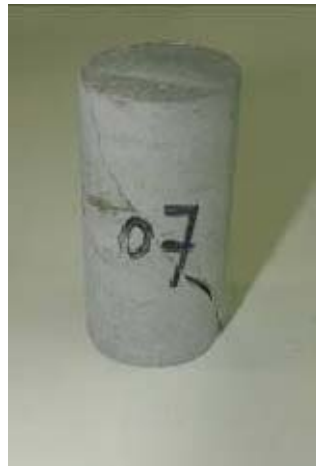
Photo A14 Un échantillon testé lors d'un essai de compression triaxiale drainée sous température imposée.
