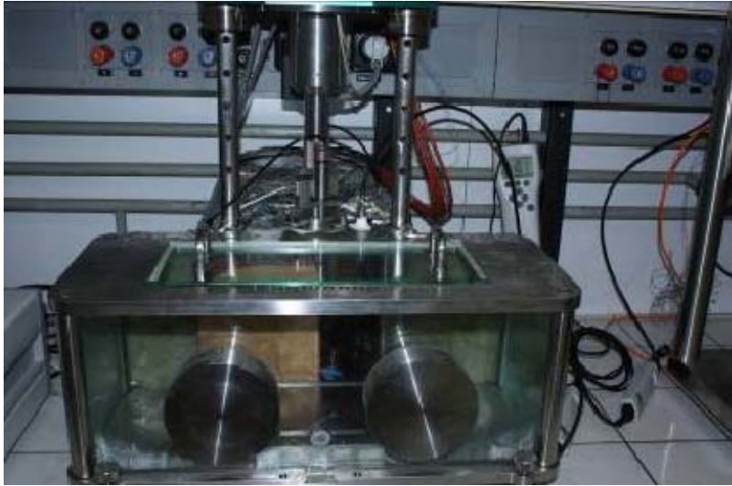
Photo A7 Dispositif expérimental pour essais de micro- indentation et de mini compression à température et humidité relative contrôlées.
