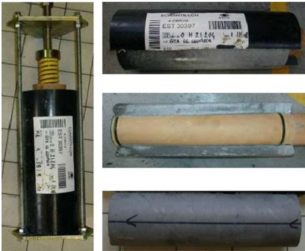
Photo A1 : Photo d'une cellule de confinement.
