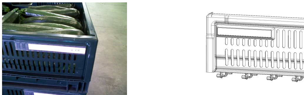
FIGURE 2.5 – Test de positionnement du tag et modification de la caisse
