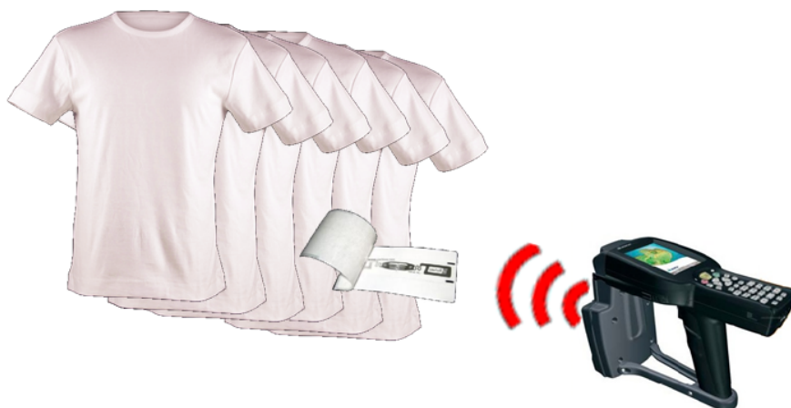
FIGURE 2.21 – Inventaire RFID avec un lecteur mobile
