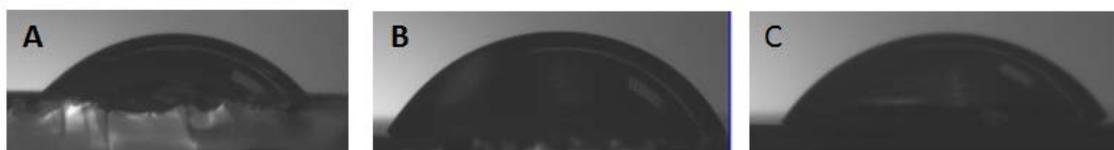
**Figure 15** : Photos montrant l'évolution de l'angle de contact de la surface pour les différentes étapes de fonctionnalisation : (A) après silanisation, (B) après incorporation de l'azide, et (C) après « click » avec le cyclophane.
