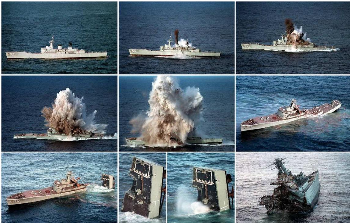
**FIGURE 1.1** – Exemple de ruine complète de poutre navire suite au torpillage du destroyer d’escorte australien *Torrens* (2700 T) dans le cadre d’un tir d’essai de la torpille Mark-48 ( $\approx 500$  kg TNT) le 14 juin 1999, lancée depuis le sous-marin HMAS *Farncomb* de la classe *Collins*.
