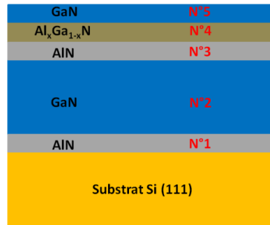
Figure II. 3 : Représentation des structures III. La structure formée par une couche de nucléation en AlN, une couche tampon en GaN suivie d'un espaceur et d'une barrière d'AlGaN et d'une couche de GaN de passivation.
