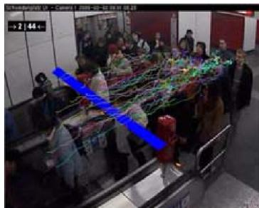
FIGURE 2.27 – Détection et suivi des personnes sur un quai de métro
