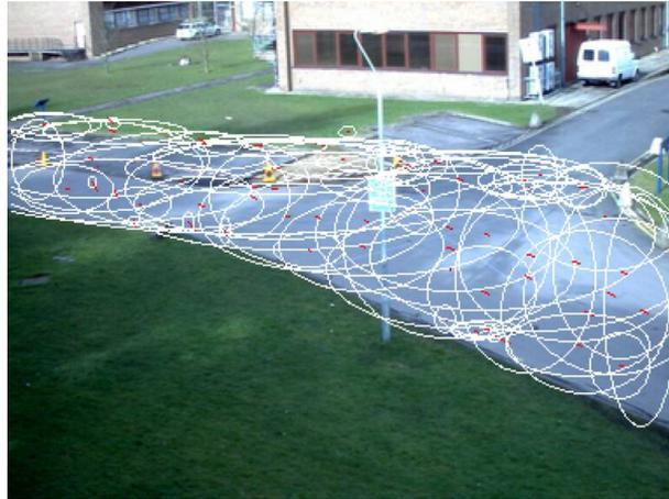
FIGURE 2.20 – Illustration des moyennes des gaussiennes d'un mélange Gaussien à quatre dimensions ( $x, y, v_x, v_y$ ). Les lignes rouges représentent la direction et la magnitude moyenne dans la position moyenne, tandis que les ellipses blanches sont proportionnelles aux variances des positions
